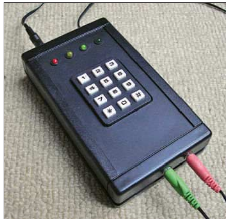
Bild 7: Handliche Aufbauvariante des Sprachverschlüsselers Hektor Foto: Thomas
