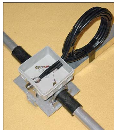
Bild 9: Die Strahlerdose mit Kabeldrossel zur Anpassung und Mantelwellenunterdrückung
