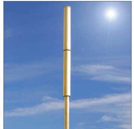
Bild 2: Fertig aufgebauter Doppelsperrtopf mit Tragrohr Foto: DJ9YW
