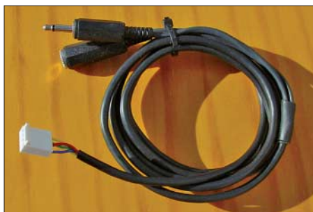
Bild 2: Es gibt fertig konfektionierte Verbindungskabel für den Anschluss des TalkSafe an das Funkgerät. Fotos: DJ4UF
