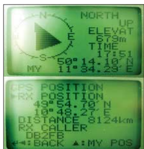
Bild 8: Absolutes ODX für 70 cm im DV-Modus: angezeigte Distanz zur Gegenstation 8124 km! (tatsächliche Entfernung unter 80 km)
