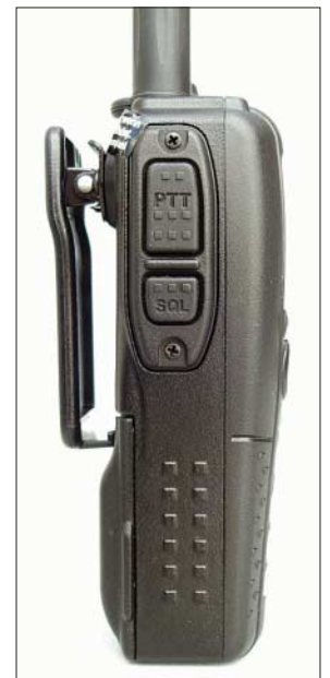
Bild 2: Blick auf die Sendetaste; der massive Clip hält das Gerät nicht nur am Gürtel fest.
