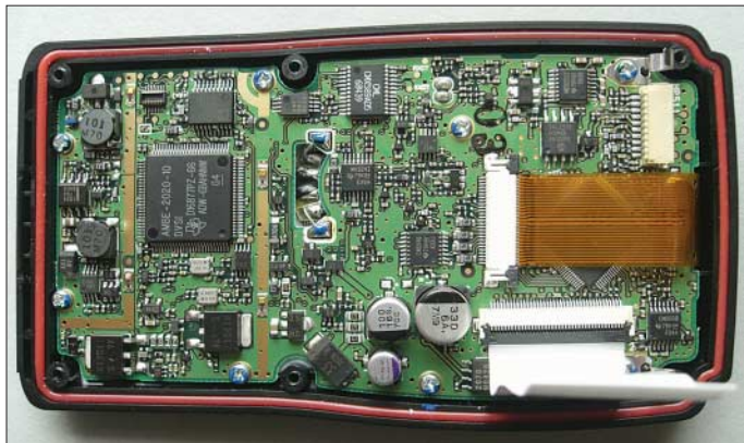
Bild 6: Im Digitalteil wird die CPU vom Display-Kabel verdeckt. Deutlich sichtbar sind hingegen der AMBE-Sprachcodec und umliegend diverse Spannungswandler und -regler.
