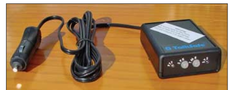
Bild 3: TalkSafe wird mittels mitgeliefertem 12-V-Kabel für die Zigarettenanzündersteckdose an die Bordversorgung angeschlossen.
