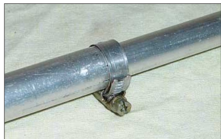
Bild 7: Verbindung zwischen 16-mm- und 12-mm-Rohren mit Schlauchschelle
