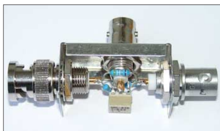
Bild 15: Fertig aufgebauter Hybridkopppler
