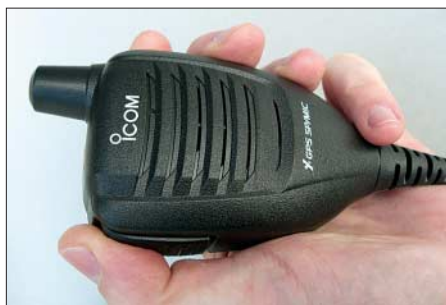
Bild 9: Das Mikrofon HM-175GPS ist die eleganteste Methode, dem Handfunkgerät die Position mitzuteilen.
