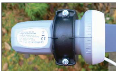
Bild 19: Der montierte LNB im Feedhalter; für Anfänger schwierig: Der LNB hat zwar eine Gradeinteilung, aber ohne Beschriftung.
