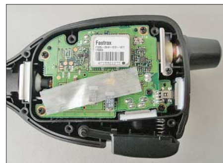
Bild 10: Im Inneren findet sich gut abgedichtet ein GPS-Empfänger. Fotos: DG1NEJ
