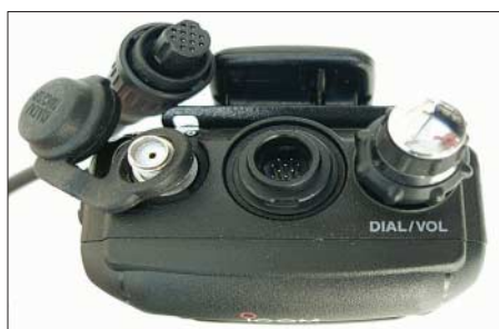
Bild 4: Eine ganz ungewöhnliche Buchse dient zum Anschluss von Mikrophon und Datenkabel.
