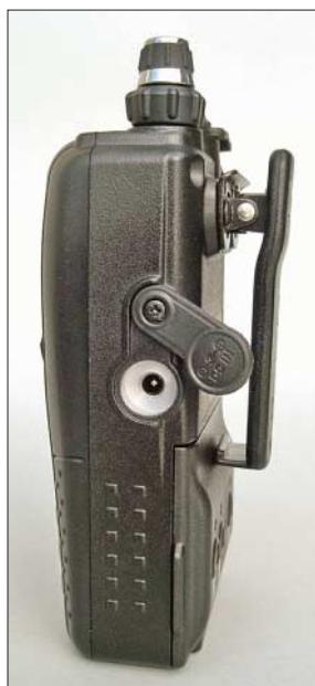
Bild 3: Alle Buchsen verfügen über Dichtungen.
