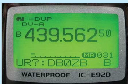
Bild 3: Hier antwortet der Repeater auf eine Aussendung ohne jede Adressierung und meldet, dass er 1. auf dieser Frequenz QRV ist und 2. keine Zieladresse erkennen konnte.
