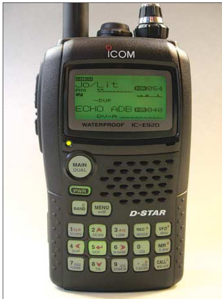
Bild 1: Display und Tastatur des IC-E92D sind beleuchtbar. Hier mit Empfang zweier abgespeicherter Frequenzen mit Spektraldarstellung im oberen Band.
