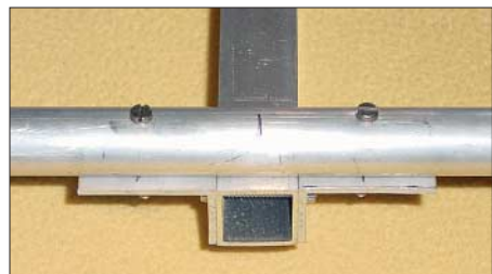
Bild 6: Elementbefestigung auf Vierkant-Boom
